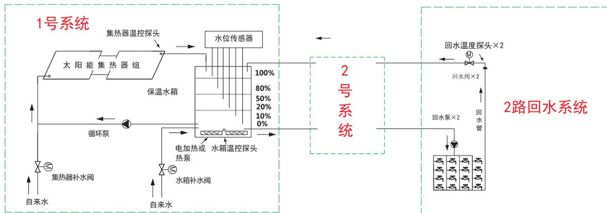
注：与1号相同的系统共2组，2组系统的水箱供水管相连共用二组回水系统及1路电伴热带
